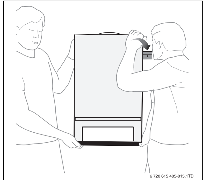
Рис. 13 Навешивание котла на настенный кронштейн
